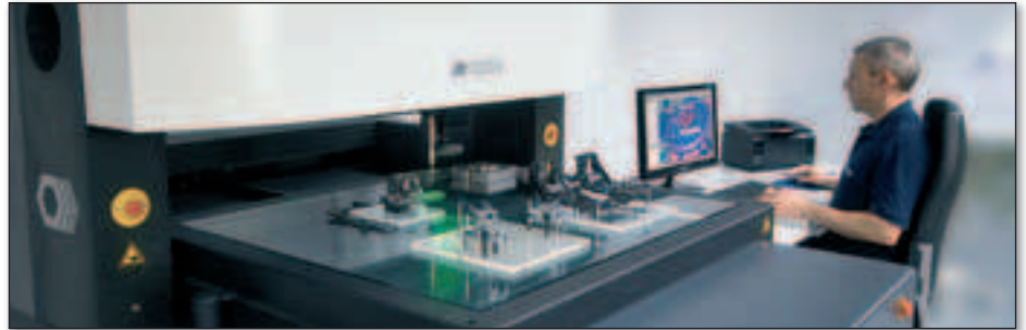
Le nouveau système multi-palpeurs OptivScan offre deux modes de mesure ultra précis. Source : Hexagon Metrology
